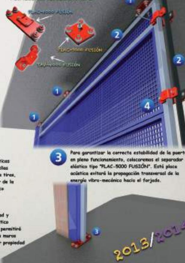
3 Para garantizar la correcta estabilidad de la puerta en pleno funcionamiento, colocaremos el separador elástico tipo "PLAC-5000 FUSIÓN". Esta placa acústica evitará la propagación transversal de la energía vibro-mecánica hacia el forjado.
